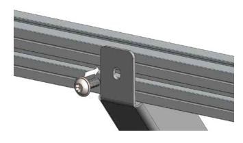
Die einzelnen Profile werden mit dem Profilverbinder und jeweils 4 gewindeformenden Schrauben M8x20 miteinander verschraubt. Zwischen den Profilen ist ein Freiraum von 5 mm frei zu lassen.
